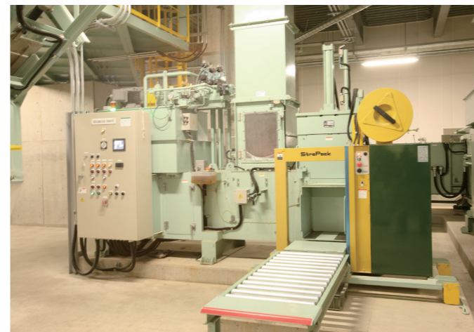
■雑紙圧縮梱包機 選別された雑紙を圧縮し梱包します。
