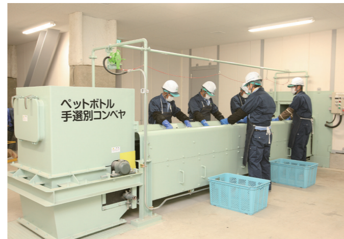
■手選別室 手作業により異物や処理不適物を取り除きます。
