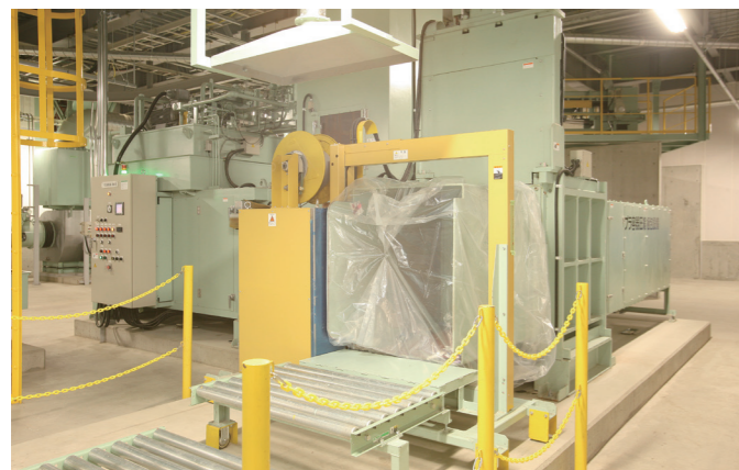
■プラ容器圧縮梱包機 選別されたプラ容器を圧縮し梱包します。
