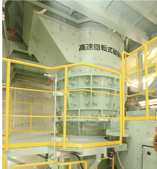
■高速回転式破砕機 衝撃・せん断・圧縮の複合破砕により、 ごみを細かく破砕します。
