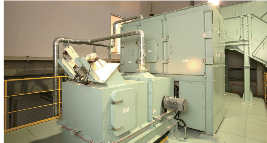
■缶類用磁選機・アルミ選別機 缶類用磁選機で磁石を使って缶の中 からスチール缶を取り出します。 更に缶類用アルミ選別機で磁石との反 発力を利用してアルミ缶と残渣に選別 されます。
