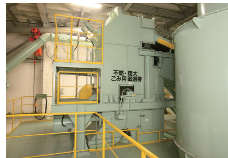
■不燃・粗大ごみ用 磁選機 電磁石を使って破砕物の中 から鉄を取り出します。
