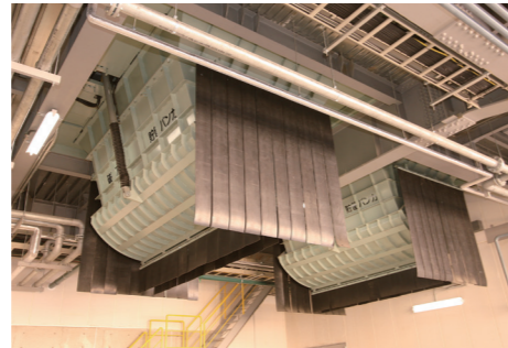
■貯留バンカ 回収された破砕鉄・破砕アルミはそれぞれ の貯留バンカに貯められ、場外へ搬出され ます。
