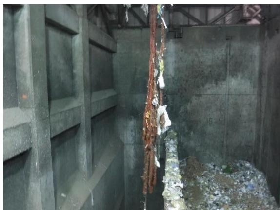
長さ 15m以上の漁網が、処理設備に絡まり設備停止の原因になります。
